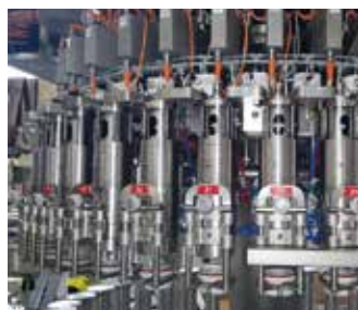
La supervisione in tempo reale delle curve di riempimento permette di aggiornare il ciclo per ottenere il massimo potenziale dalla macchina. La correzione "on line" è grazie all'attivazione del "Recovery System", basato sull'acquisizione dei dati di riempimento di ogni singola bottiglia
